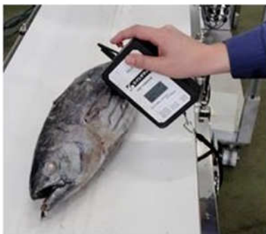
写真1 試作した測定器と冷凍カツオの測定
